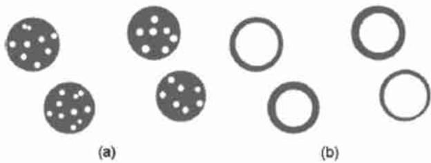
图 5 在不相容聚合物共混物中粒子包裹粒子 (a) 复合粒子形态; (b) 核-壳粒子形态 [13]
